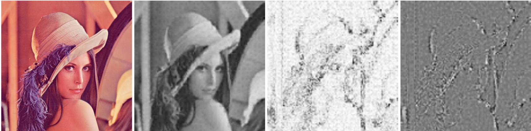
(a) imagem Lena original; (b) imagem comprimida e reconstruída usando compressão fractal; (c) imagem de diferença absoluta ampliada e (d) imagem de diferença relativa ampliada
