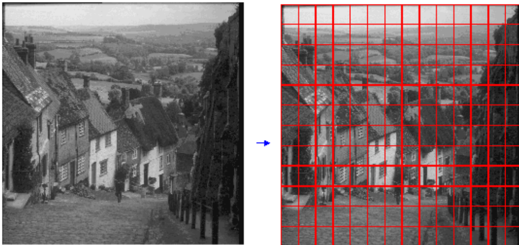
Figura 6. Divisão da imagem em blocos para cálculo da DCT.
