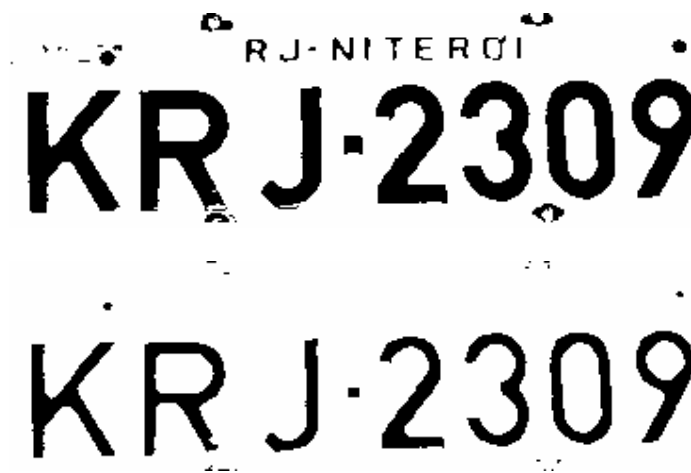
Figura 1.8 – Imagem antes e depois da erosão
