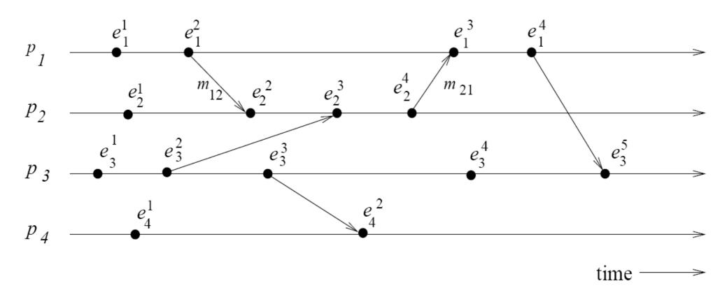
Figura 2.2: Diagrama espaço-temporal de execução distribuída.
