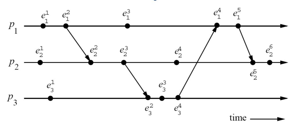
Figura 2.1: Diagrama espaço-temporal de execução distribuída.
