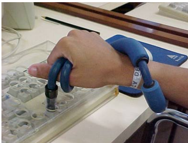
Figura 1 Colméia de acrílico com estabilizador de punho com pino Fonte: Damasceno, Filho, 2002
