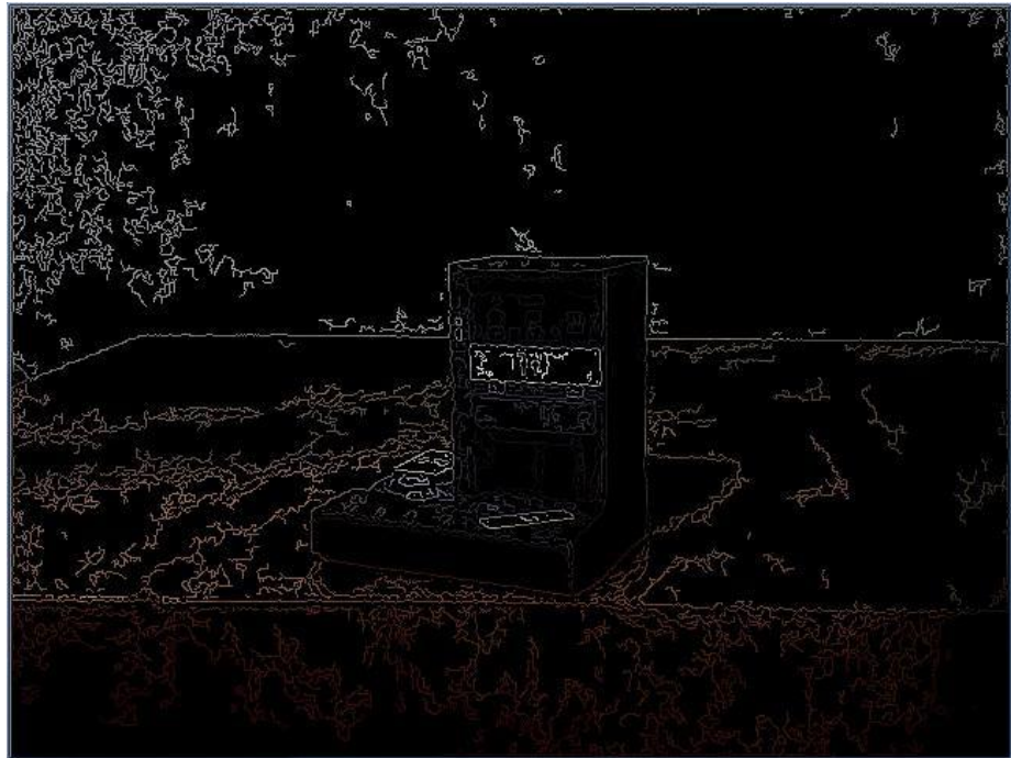
Figura 7 – Resultado do método de Canny aplicado a figura 2.
