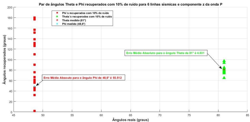
Figura 4.9: Relação entre um par de ângulos  $\theta$  e  $\phi$  reais e recuperados considerando ruídos numéricos de 10%, para o caso de seis linhas sísmicas medindo apenas a componente z da onda P, e o Erro Médio Absoluto como métrica de distância entre valores recuperados e os reais.
