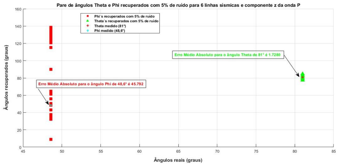
Figura 4.8: Relação entre um par de ângulos  $\theta$  e  $\phi$  reais e recuperados considerando ruídos numéricos de 5%, para o caso de seis linhas sísmicas medindo apenas a componente z da onda P, e o Erro Médio Absoluto como métrica de distância entre valores recuperados e os reais.
