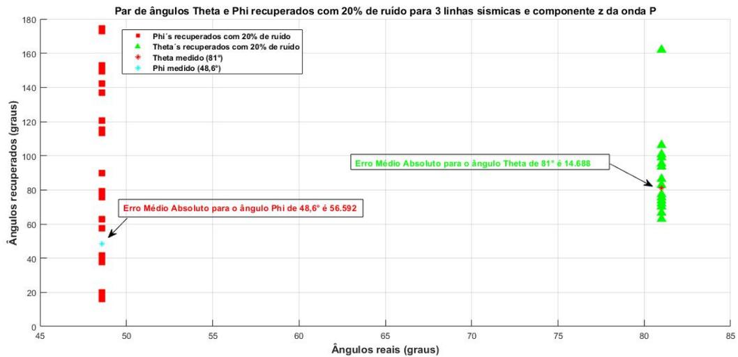
Figura 4.21: Relação entre um par de ângulos  $\theta$  e  $\phi$  reais e recuperados considerando ruído numérico de 20%, para o caso de três linhas sísmicas medindo apenas a componente z da onda P, e o Erro Médio Absoluto como métrica de distância entre valores recuperados e os reais.
