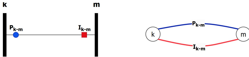
Figura 34: Representação de medidas de fluxo de potência e corrente de ramo num multigrafo de medições \mathcal{Z}_M .
