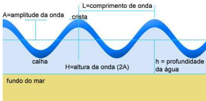
Figura 2 - Onda harmônica ou senoidal
