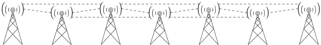
Figura 1.1: Exemplo ilustrativo de topologia linear em que os nós são dispostos em linha mas a redundância de enlaces forma uma rede em malha.
