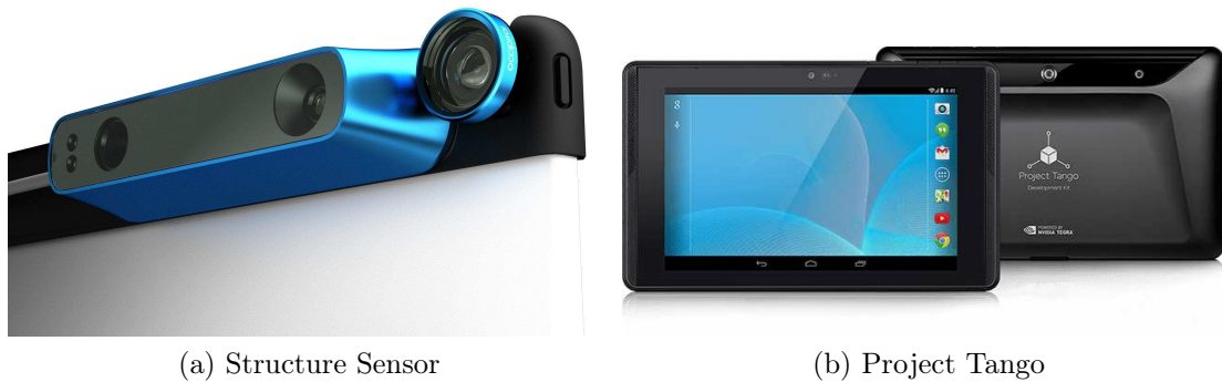
Figura 6.1: Dispositivos utilizados para captura de imagens de profundidade dados e para a execução de todo o algoritmo de reconstrução.
