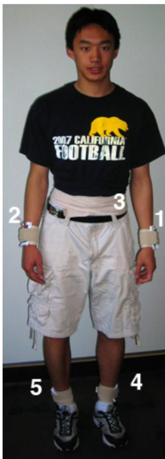
Figura 3.2: Usuário do trabalho de A. Yang equipado com 5 acelerômetros [9]
