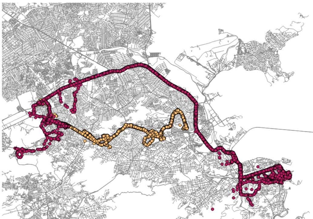
Figura 4.1: Posições dos ônibus da linha 908 durante o mês de Fevereiro de 2016. Dois tipos de operação em uma mesma linha de ônibus. As informações em amarelo e vermelho foram produzidas por dois diferentes conjuntos de ônibus da mesma linha.
