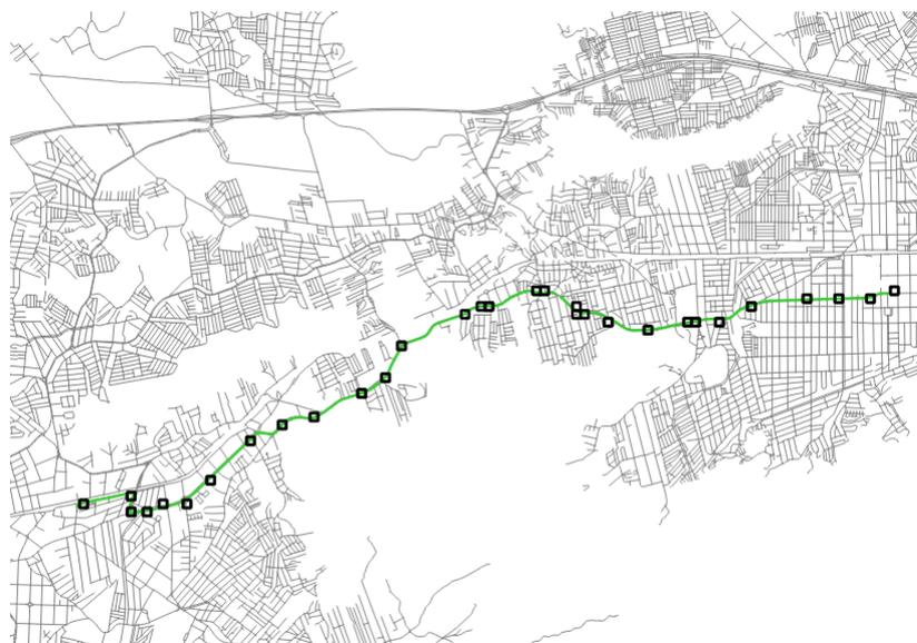
Figura 6.5: Análise das células do grid com dimensões de 100 metros quadrados pertencentes a rota 1 da linha 864 através da análise de 1 dia de operação, que são interceptadas pela rota original representada por um conjunto de segmentos de rua de cores verdes.
