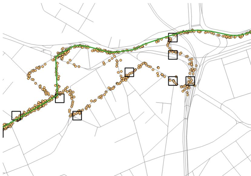
Figura 6.7: Resultado da criação das células do grid da linha 422 analisando-se 1 dia de operação. Podemos observar a existência de informações de posicionamento (círculos amarelos) que não seguem os segmentos da rota verdadeira, que são representados através da cor verde. Tais posições são frutos de desvios realizados por diferentes veículos ao longo do dia.
