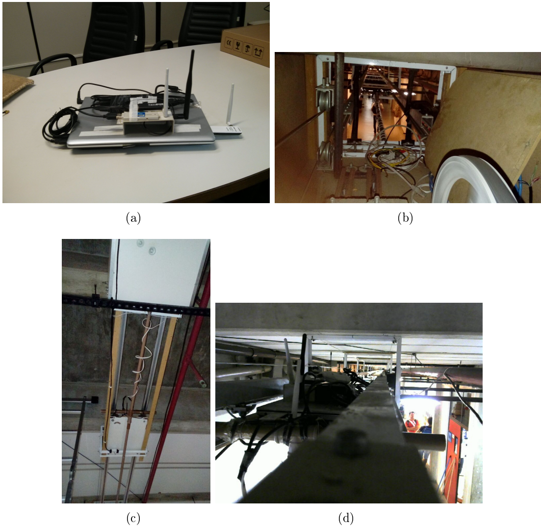
Figura A.3: Fotos do trem e do laptop que é acoplado a ele para a realização de testes com mobilidade: (a) laptop com interfaces IEEE 802.11 conectadas; (b) engrenagens do trem; (c) o trem visto por baixo, ao lado da estação ORG; (d) vista de trás do trem e corredor ao fundo.
