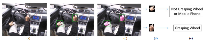
Figura 3.3: Visão geral de Siddharth et al. [55]: (a) Imagem original (b) Detecção de mãos (c) Classificação de pele a nível de píxel (d) Extração de mão localizada (e) Classificação de intenção do motorista. (Fonte: [55])
