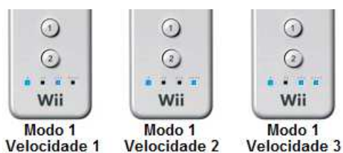
Figura 20: Disposição dos dois últimos LEDs para cada velocidade do modo 1 ( default ) de operação.
