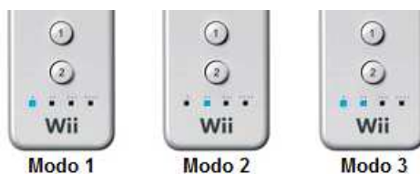
Figura 19: Disposição dos dois primeiros LEDs do Wiimote para cada modo de operação.
