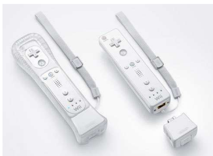
Figura 13: Integração do Wii Motion Plus™ com o Wiimote . Imagem retirada de http://assets.gearlive.com/playfeed/blogimages/wii-motion-plus.jpg
