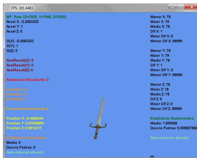
Figura 15: Aplicação de teste utilizada durante o processo de desenvolvimento da etapa de interpretação do sinal do Wiimote . Nas laterais estão as informações de debug geradas.
