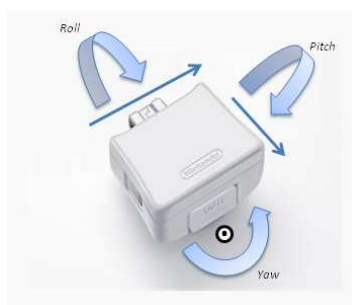
Figura 14: Eixos de rotação detectados pelo Wii Motion Plus™. Imagem retirada de http://rosseto.files.wordpress.com/2009/11/gyro1.png?w=349&h=297
